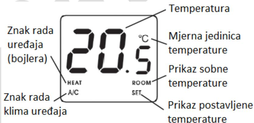
Ovaj bežični (radio frekvencijski) termostat se može po potrebi lako proširiti i sa utičnicom Q1RX kojom je termostat u stanju upravljati bojlerom ili bilo kojim drugim električnim uređajima koji rade na 230V (50HZ, max. 16A) (npr. grijalice, pumpe, zonski ventili, itd.) prema sobnoj temperaturi. (Detaljne informacije i preporučeno korištenje COMPUTHERM Q1RX utičnice možete pronaći na web stranici [www.computherm.com.hr](http://www.computherm.com.hr)).
